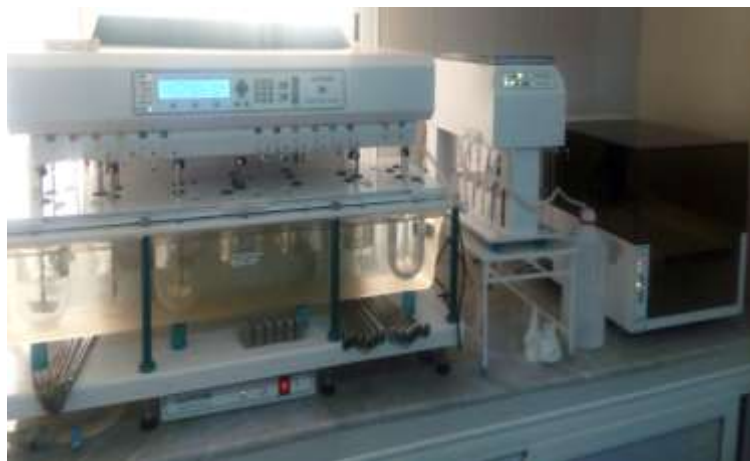
Figure 16 : Appareil de dissolution à palette tournante.
