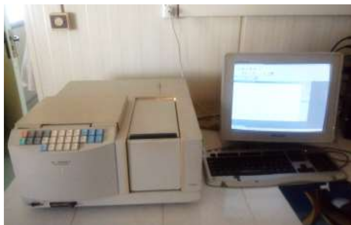
Figure 17 : Spectrophotométrie UV/Vis double faisceau.
